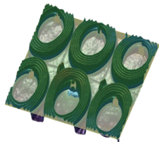
비장착 PCB 서브스트레이트의 평면성 검사
