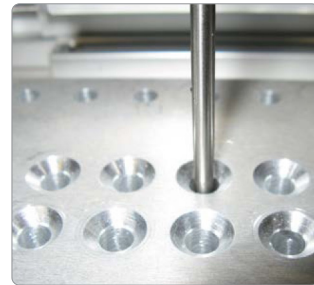
IFS2402/90 센서를 사용한 작은 타공의 직경 측정
