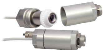
측정 오류를 방지하기 위해 렌즈를 항상 청결히 유지해주시요. 에어 퍼지 칼라로 오류 발생률을 감소시킬 수 있습니다.
