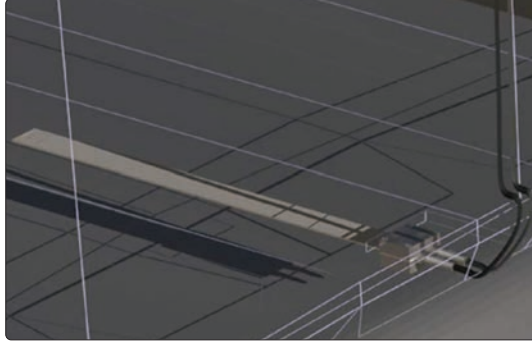
발전기의 로터 간격 측정 MD6-22는 발전기의 시운전 및 유지 보수에 사용됩니다. 로터 사이의 갭에 박형 센서를 위치시킨 후 거리를 측정합니다.
